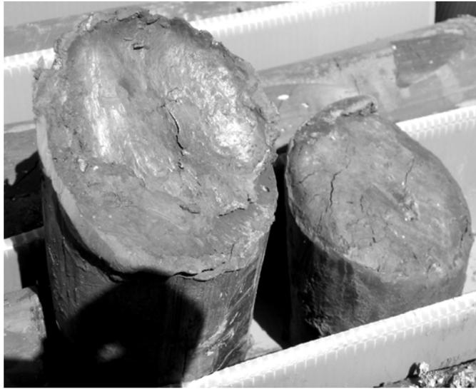
**Fotografía 3:** Superficie pulida en testigo de sondeo.
